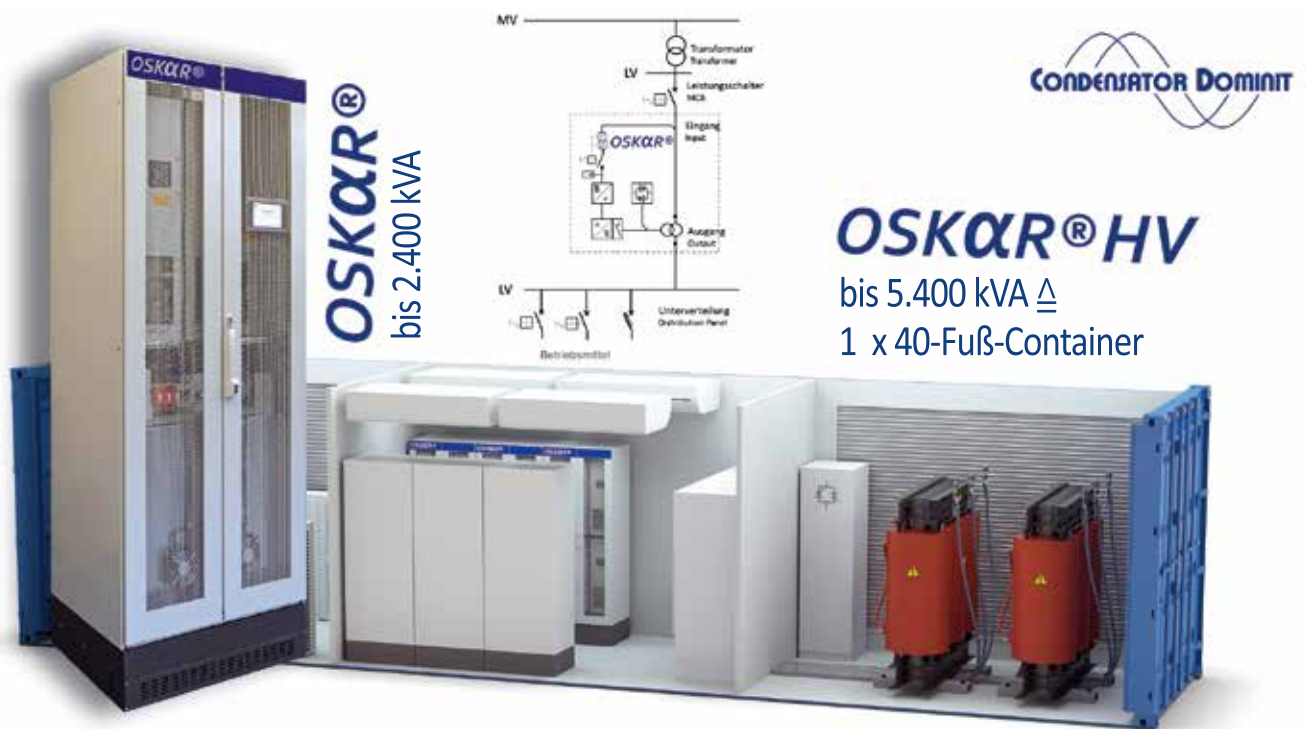
Bild 8. Effiziente Spannungsstabilisierung durch das aktive Netzspannungsreglersystem Oskar (Online Spannungs-Korrektur mit adaptiver Regelung) – als Schranklösungen von 300 bis 2 400 kVA, bis hin zu Leistungen von 5 400 kVA als Oskar-HV im 40-Fuß-Container erhältlich
