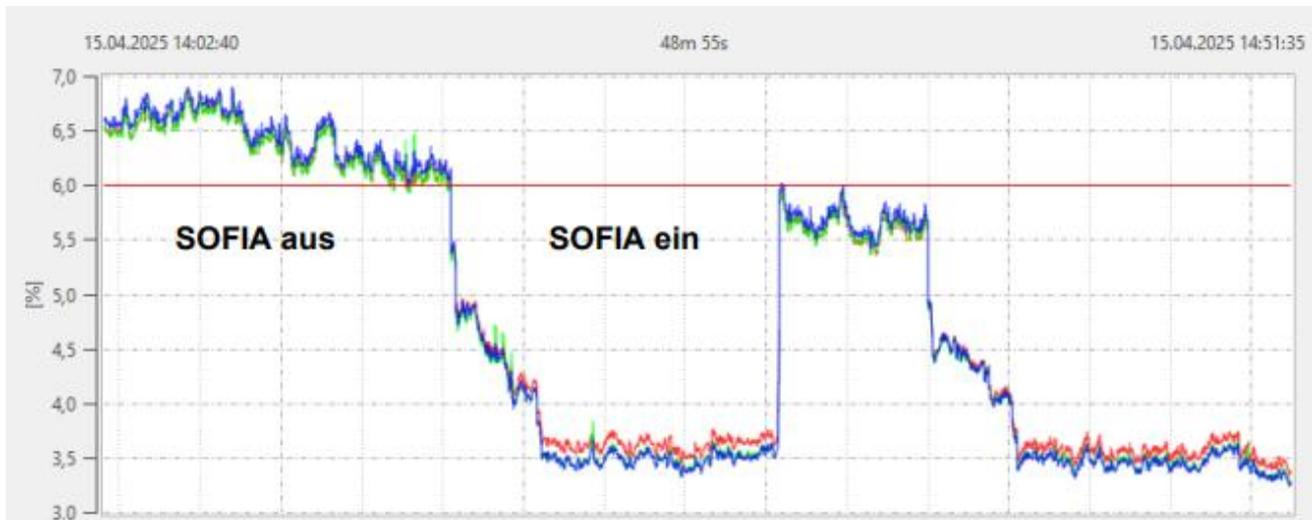
**17. und 19. Harmonische der Spannung in Prozent verglichen mit den Grenzwerten (2% und 1,8%) der Norm IEC 61000-2-4 EMV-Klasse 2**
